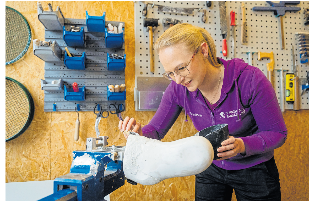
Aurelia Schnitzlein-Funk erstellt einen Probeschaff für eine Beinprothese. Damit den Patienten am Ende nichts drückt, muss sie so nah wie möglich an die Anatomie des Menschen herankommen. Fotos: JAP-Fotografie
